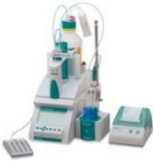
Укомплектованный компактный титратор Salt Titrino plus на базе титратора 848 Titrino plus был разработан для анализа хлорид-ионов в различных образцах.
